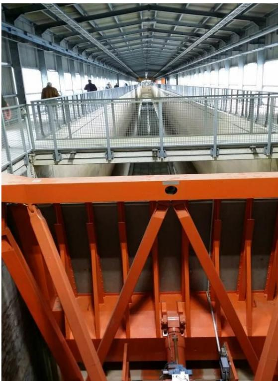
**Abb. 1.** Wellenkanal mit Wellenmaschine (Foto: Elger)
